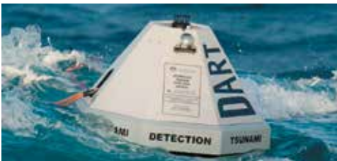
Поверхневий буй для попередження про цунамі
