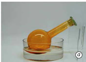
Мал. 11.4. Нагрівання рівноважної суміші ( 2\text{NO}_2 \rightleftharpoons \text{N}_2\text{O}_4 ) зміщує рівновагу в бік розкладання димеру, про що свідчить посилення червоно-коричневого забарвлення (а), а під час охолодження рівновага зміщується в бік утворення димеру, і суміш знебарвлюється (б)
