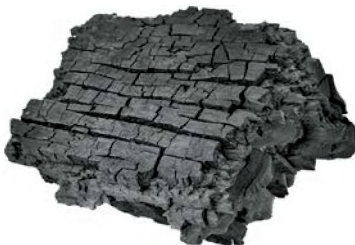
Мал. 28.6. Деревне вугілля зберігає структуру деревини
