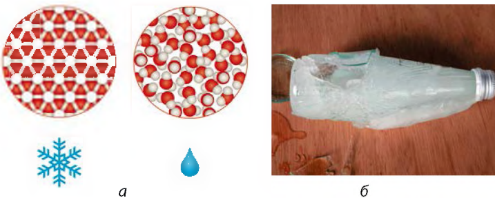
Мал. 7.5. У рідкій воді молекули води розташовані неупорядковано та близько одна до одної; у льоду молекули розташовані впорядковано й на більшій відстані, тому лід легший за воду (а). Під час замерзання вода розширюється, внаслідок чого закрита скляна пляшка з водою в морозилці тріскається (б)
