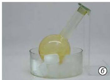
Мал. 11.4. Нагрівання рівноважної суміші ( 2\text{NO}_2 \rightleftharpoons \text{N}_2\text{O}_4 ) зміщує рівновагу в бік розкладання димеру, про що свідчить посилення червоно-коричневого забарвлення (а), а під час охолодження рівновага зміщується в бік утворення димеру, і суміш знебарвлюється (б)
