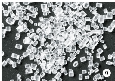
Мал. 9.1. Кристалічний цукор (а) після розплавляння та швидкого охолодження стає аморфною речовиною, з якої легко виготовляти ледяники (б) та карамельки (в)
