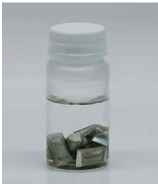
Мал. 33.1. Натрій зберігають під шаром рідких вуглеводнів
