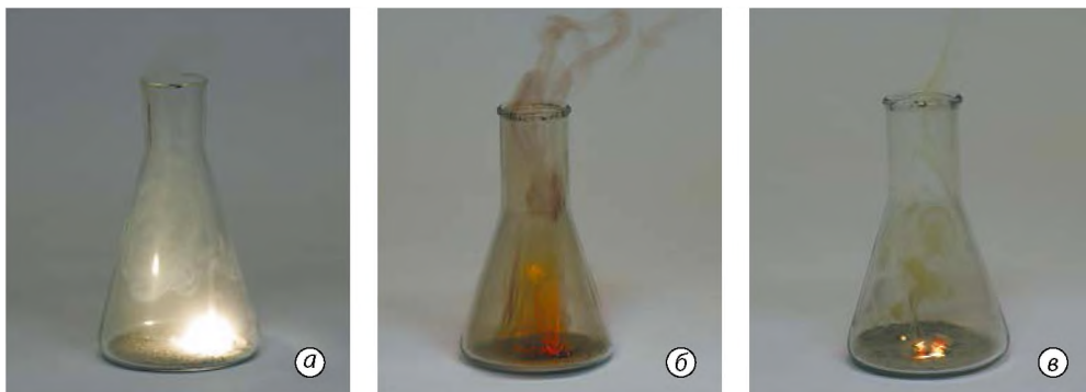
Мал. 16.1. Взаємодія з хлором магнію (а), заліза (б) і міді (в)
