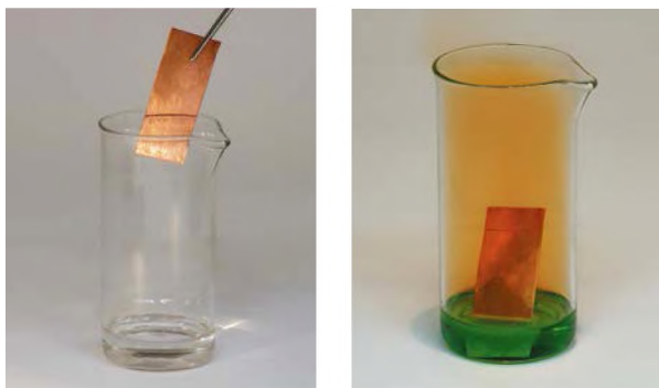
Мал. 25.1. Взаємодія міді з концентрованою нітратною кислотою
