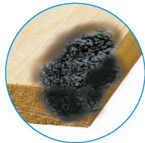
Мал. 22.2. Обвуглювання деревини концентрованою сульфатною кислотою
