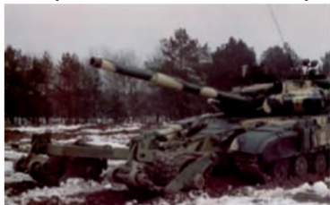
Іл. 12.3. Танк з мінним тралом
