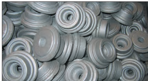
Мал. 2. Вироби з високоміцного сірого чавуну. На сировину та паливо припадає до 90% усіх витрат при виробництві чавуну. Для того щоб виплавити 1 т цього металу, потрібно 1,2—1,5 т коксівного вугілля, 1,5 т залізної руди, понад 0,5 т флюсових вапняків, 200 кг марганцевої руди і до 30 м 3 води.
