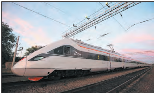
Мал. 7. На Крюківському вагонобудівному заводі створили швидкісний двосистемний електропоїзд ЕКр1 «Тарпан» (зараз курсують два поїзди). Для цього завод кооперується зі 180 підприємствами України, а також із зарубіжними партнерами, що й постачають вузли та комплектуючі. Електропоїзд може перевозити до 600 пасажирів.
