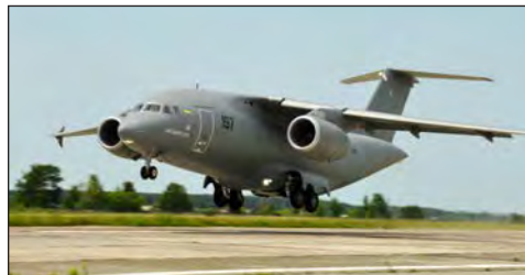
Мал. 5. Літак Ан-178 — військово-транспортний літак, створений із застосуванням найсучасніших світових авіаційних технологій, призначений для доставки особового складу, озброєння та легких військових машин, перевезення матеріальних цінностей, пошти та інших вантажів.
