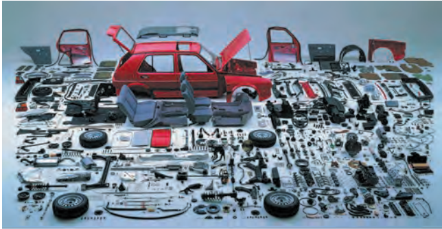
Мал. 3. Деталі автомобіля. Сучасні автомобілі мають не тільки традиційні вузли та агрегати (кузов, шасі, двигун, паливна система тощо), а й складні комп'ютерні системи й елементи автоматизації. Це робить їх зручними й безпечними в експлуатації, але водночас досить складними в обслуговуванні.
