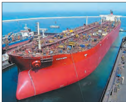
Мал. 4. Японський супертанкер «Кнок Невіс» понад три десятиліття був найбільшим судном світу. Довжина супертанкера становить 458 м, а ширина — 69 м (за розмірами це п'ять футбольних полів). Він був здатен перевозити понад 500 тис. т нафти.
