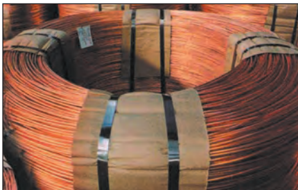
Мал. 2. Мідні драти. Завдяки високій електропровідності мідь використовується в електротехніці для виготовлення дротів, кабелів, струмопровідних частин електротехнічної апаратури.
